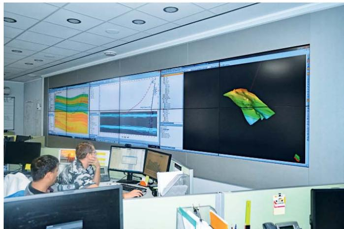
На одном из экранов – работа на скважине месторождения имени Романа Требса в Ненецком автономном округе. Реальное время, постоянное бесперебойное поступление информации на серверы центра. Посмотрите, в процессе бурения нам с небольшим отставанием от движения долота поступают данные о пространственном положении скважины и геофизические показатели, на основании которых складывается общая картина, позволя-
