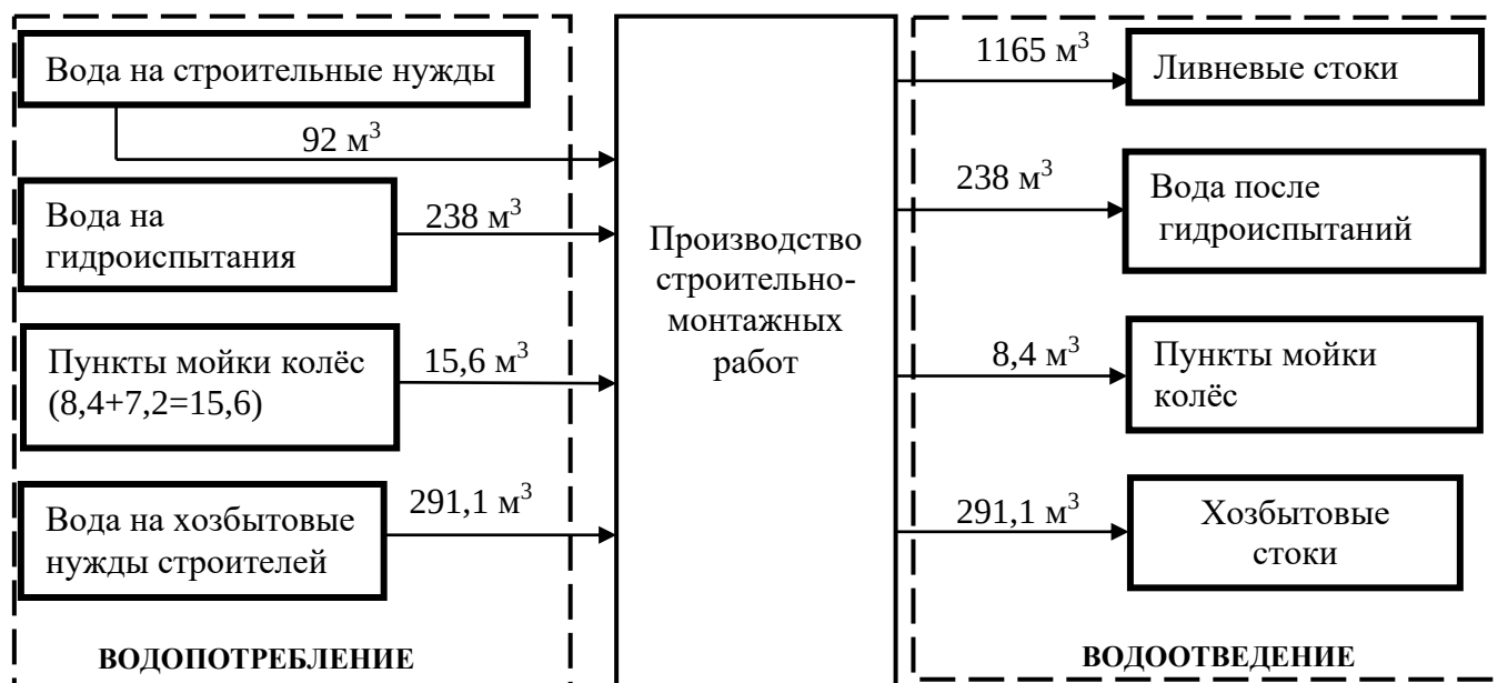
Рисунок 6.5.1 –Схема водоснабжения и водоотведения в период СМР
